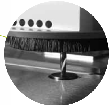
自動ツールレベリングは、あらゆる Kongsberg XP ツールの垂直動作位置を正確に自動補正する感圧パッドです。
