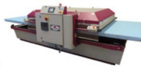
作業テーブルが2枚あることで、生産効率が上がり、オプションのパキュムシステムにより生地への浸透性が向上します。
